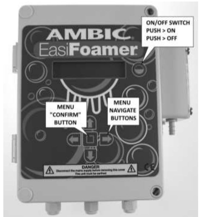
Fig. 6 - FUNCIONAMIENTO Y CONEXIONES ELÉCTRICAS DEL INTERRUPTOR DEL EASIFOAMER
