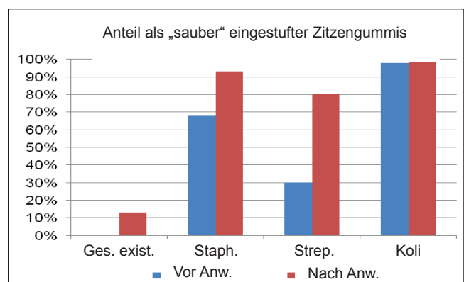
Abb. 2: Illustration der Wirksamkeit der PeraSpray-Anwendung mit einem Schwellenwert von < 100 KBE vor der Desinfektion und von < 50 KBE nach der Desinfektion, unterhalb dessen das Zitzengummi als „sauber“ gilt
