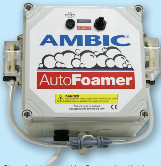
El corazón del sistema del AutoFoamer es la unidad de poder que utiliza bombas peristálticas para bombear el producto químico a una presión baja constante. Cuando es combinado con el suministro de aire comprimido a baja presión, a una razón apropiada, esta unidad es capaz de generar espuma con una estructura y calidad óptimas para el tratamiento eficaz de los pezones antes de la ordeña.
